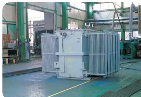
▶ 고압시험용 TR (High Voltage Test TR upto 6600V)
